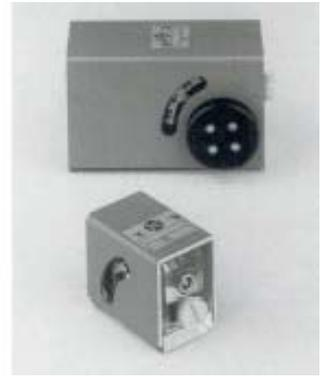
单元尺寸为20x30mm<sup>2</sup>，频率为1、2和4MHz的通用斜探头UWB.和MUWB.
