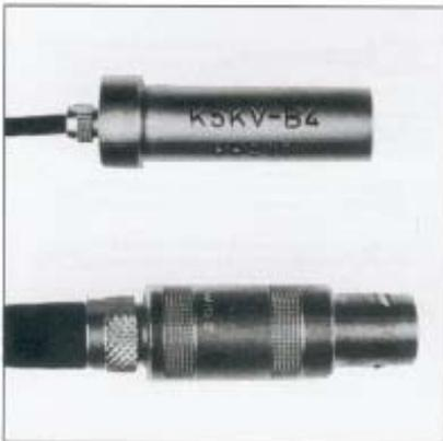
← K5KV-B4: 有耐热延迟线的直探头, 用于在吹气工艺中对吹气模具进行壁厚测量。频率和单元尺寸可以根据测试条件进行选择。
