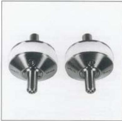
← B1K/S+B1K/E, SEB4NW: 滚筒式探头, 用于干耦合 (不用耦合剂), 特别使用在具有高声波衰减性的多孔和合成材料的穿过式检测或作为TR探头使用。
