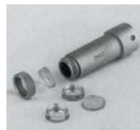
聚焦透镜LKL和LKP，以及为Z..K探头安装聚焦透镜的适配器ZKQ2
