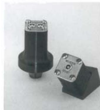
用于机器测试的探头必须在变化的温度和牢固度的情况下满足水密性的要求。为了获得高的测试速度和测试可靠性，通常在一个探头组包含有很多的探头单元。
