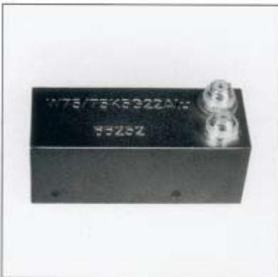
← W75/75K5G22: 双单元斜探头, 采用串联方法测试金属, 如铝制冷热器上焊接穿透深度的确定。频率5MHz, 单元尺寸8×9mm, 入射角度75°。有其它尺寸结构。
