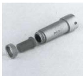
延迟线和为Z..K探头安装延迟线的适配器ZKQ2
