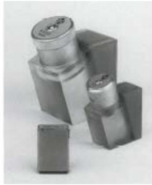
带KSY45、WRY45和WSY70的粗晶斜探头K0.5S
